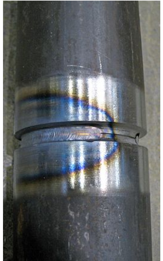
Lasverbinding van twee buizen
